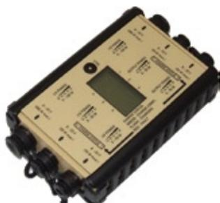
Der **SFC Power Manager** ermöglicht als universelle Schnittstelle Kompatibilität und Energiemanagement zwischen zahlreichen Stromquellen und vielfältigen Endgeräten sowie wieder aufladbaren Batterien. Besonders praktisch: der Benutzer kann sich das Mitführen vieler unterschiedlicher Batterietypen und damit entscheidend Gewicht sparen.
